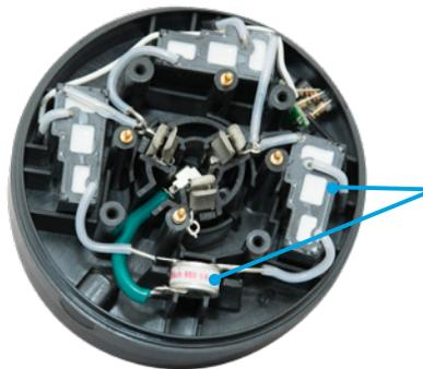
El circuito híbrido GDT / TMOV elimina las fugas y sigue la corriente extendiendo la vida útil del protector contra sobretensiones.
